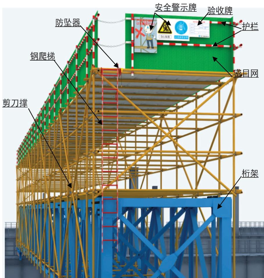
移动式桁架操作平台局部效果图
