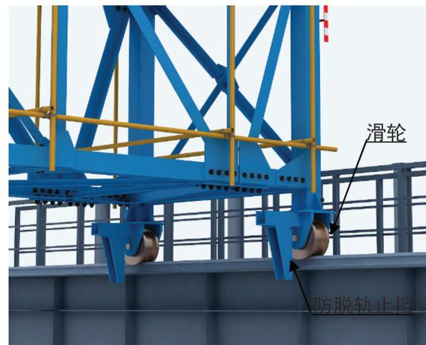
桁架滑轮节点示意图
